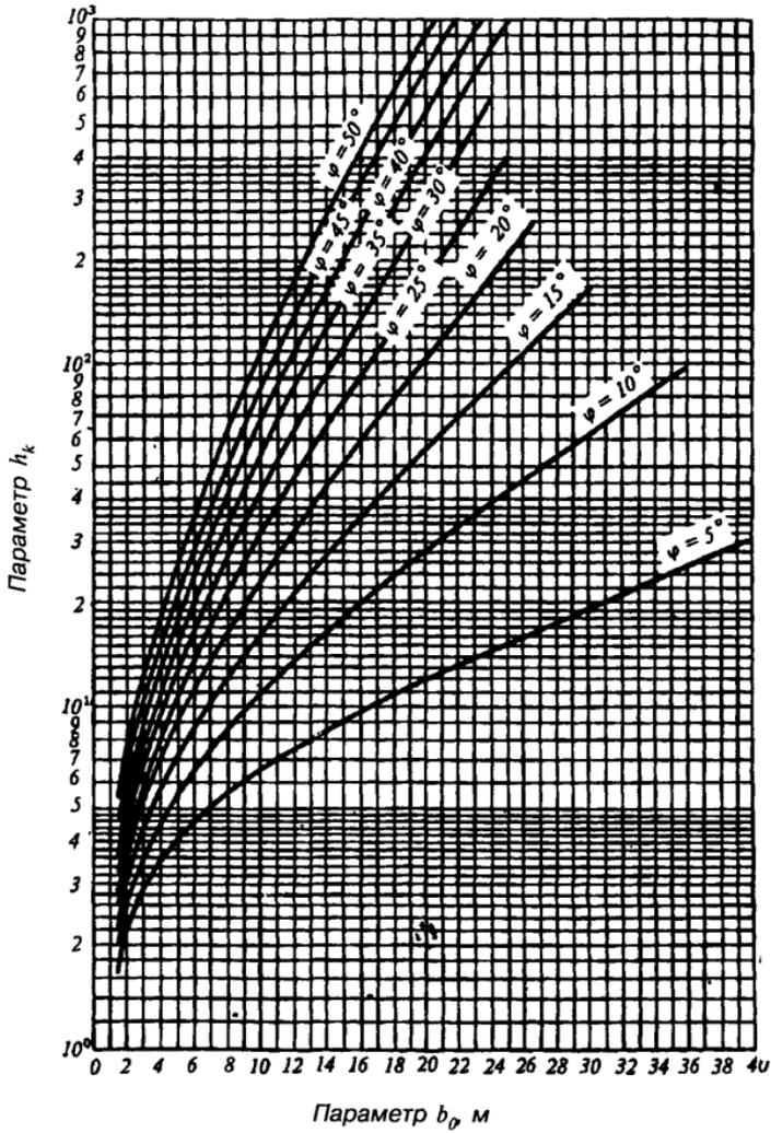
Черт. 6. Графики для определения параметра  $b_0$
